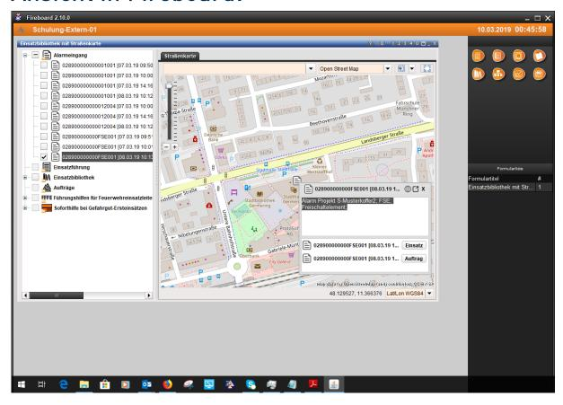
Der Text: "Alarm Projekt S-Musterkoffer2; FSE; Freischaltelement; "kommt aus der BMA und kann dort hinterlegten bzw. zugeordneten Text enthalten, wie z.B. die Meldernr., Meldergruppe, Art des Melders, wichtige Hinweise usw.
